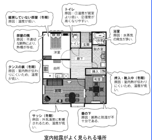
室内結露がよく見られる場所
